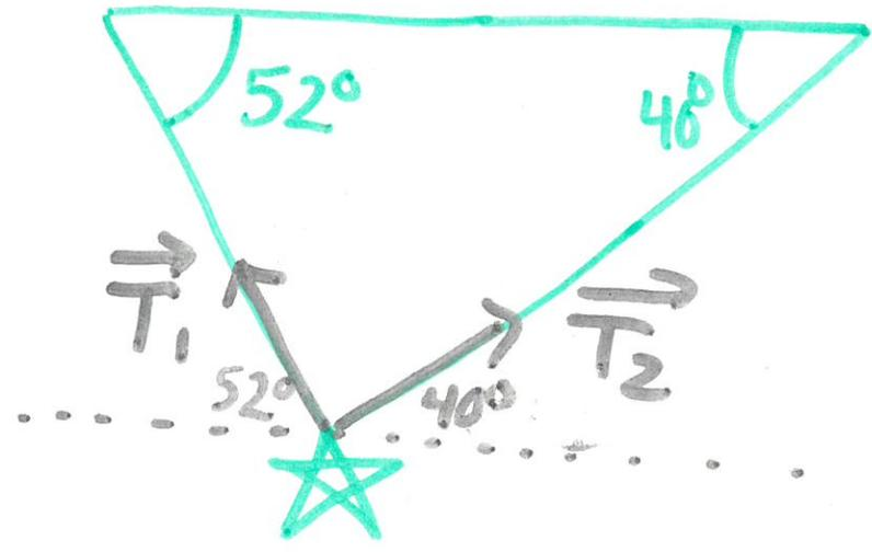
$$\vec{T}_1 = \langle -T_1 \cos 52^\circ, T_1 \sin 52^\circ \rangle$$
